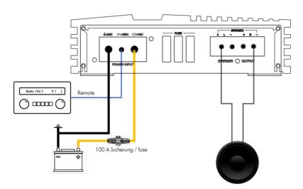
Geringste Lautsprecherimpedanz 4  $\Omega$ Minimum speaker impedance 4  $\Omega$
