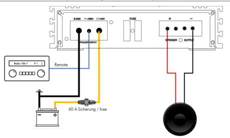
Geringste Lautsprecherimpedanz 1  $\Omega$ Minimum speaker impedance 1  $\Omega$
